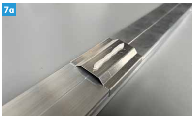
7a Am Rand werden die Plattenbeläge mit DiProtec® FIX-MSP auf die TerraMaxx® RS Schubsicherung geklebt, diese wird mittig unter der äußersten Belagsplatte positioniert. Empfohlen bei offenen Belagsfugen, nicht erforderlich bei geschlossenen Belagsfugen mit MorTec® SOFT.
